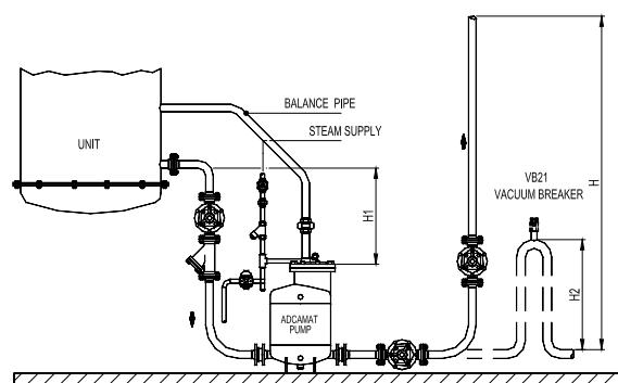
**ОТВОД КОНДЕНСАТА ИЗ СИСТЕМ ПОД ВАКУУМОМ**
