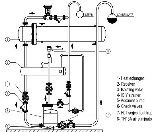
**ПЕРЕКАЧКА КОНДЕНСАТА В СИСТЕМАХ ПОД ДАВЛЕНИЕМ С ИСПОЛЬЗОВАНИЕМ КОМБИНАЦИИ НАСОСА ADCAMAT И КОНДЕНСАТООТВОДЧИКА**
